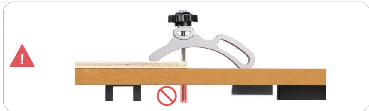
3. 参阅本说明书的 6.1 章节：组装 CNC 雕刻和切割机，将 CNC 雕刻和切割平台固定在支撑平台上。
