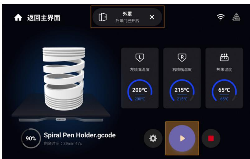
若你需要在 3D 打印或 CNC 作业期间频繁打开外罩门，且不希望作业流程随开门而暂停，可关闭对应场景下的开关门检测功能。
