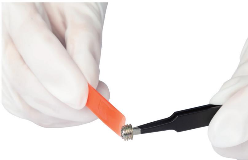
6. 将螺母安装到 CNC 雕刻和切割平台的孔中，并按压片刻。然后，等待至少 24 小时，确保混合胶水固化后再使用。
