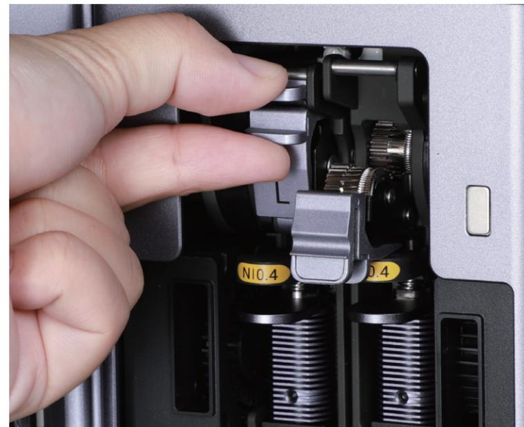
4. 用软毛刷将挤出轮附近的料屑清理干净。
